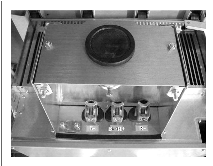
그림6-20. FR9의 DC와 제동 저항기 단자: DC단자 B-와 B+표시, 저항기 단자 R+와 R-표시
